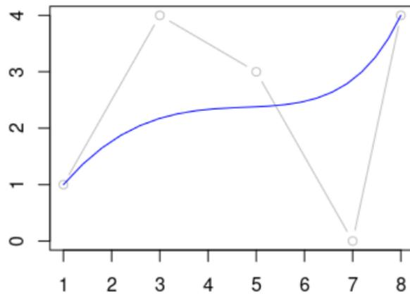
Figure 17: Resultado da implementação da curva de Bézier em R. Os pontos de controle estão em cinza e a curva em azul.
